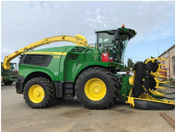
APPLI-PRO® C500 na samojízdné řezačce JD 9600i. Aplikátor pracuje v automatickém režimu. To znamená, že automaticky dávkuje konzervant podle naměřených hodnot z řezačky.
