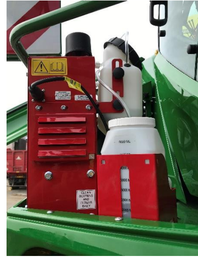
APPLI-PRO® C500 na samojízdné řezačce JD 9600i. Aplikátor pracuje v automatickém režimu. To znamená, že automaticky dávkuje konzervant podle naměřených hodnot z řezačky.
